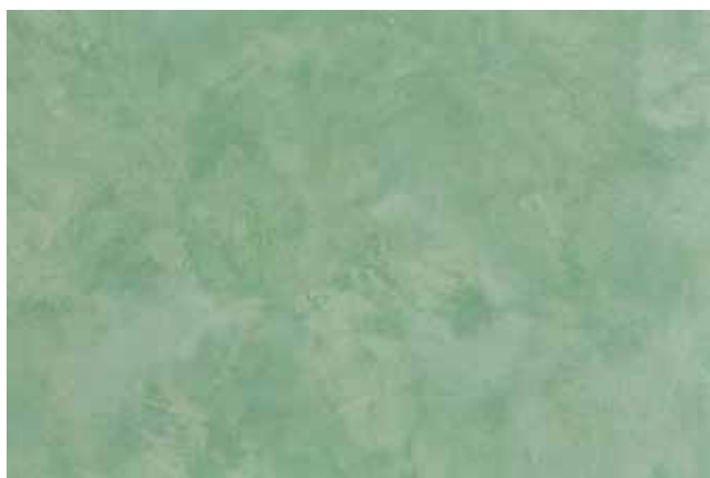
Abb. 2: Renaissanceputz (HECK ED Waschelputz fein) Kornbereich: 0–0,7 mm Putzdicke: ca. 5 mm
