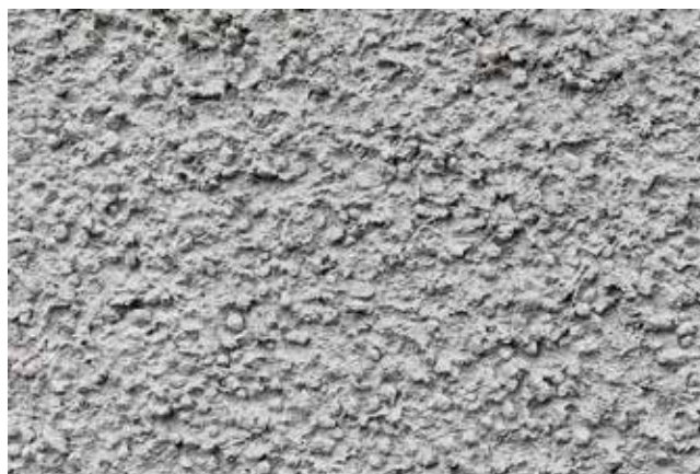
Abb. 9: Kellenwurf (Rajasil EP WD Kellenwurf grob) Kornbereich: 0–8 mm Putzdicke: 3–10 mm
