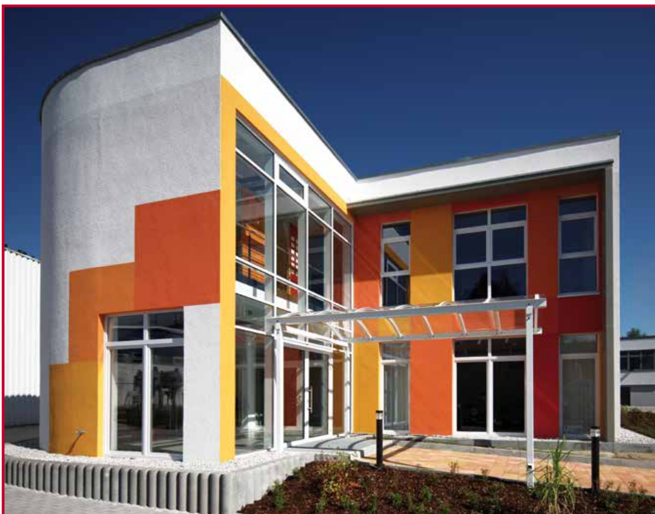
Gelungene Architektur, perfekt gedämmt: Die abgerundete Fassadenfläche des BITZ konnte nur mit dem neuen WDV-System HECK AERO gedämmt werden und steht auch nach vier Jahren tadellos und unverändert da.
