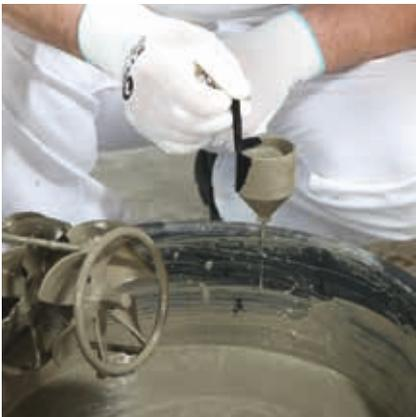
Rajasil IM 0,1 (Injektionsmörtel 01)/Rajasil IM 1,0 (Injektionsmörtel 1) wird mit einem Motorquirl knollenfrei mit sauberem Wasser angemischt. Die Überprüfung der Konsistenz kann z. B. mit einem geeignetem Auslauftrichter erfolgen.
