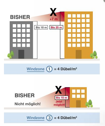
Berechnet für HECK Coverrock II 035 (BISHER) und HECK Coverrock X-2 nach dem vereinfachten Verfahren für Gebäude bis 25 m Höhe und für Höhen-Längenverhältnisse  $h/d \le 2$ , Windzonen 1 bis 4, Verdübelung oberflächenbündig auf Plattenfläche mit HECK Dübelteller 90 (VT2G / E / H).
